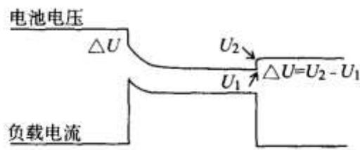
在瞬间直流情况下，蓄电池的等效模型可以认为是一个电压源和内阻串联（戴维南等效模型）所构成，如图3所示。
